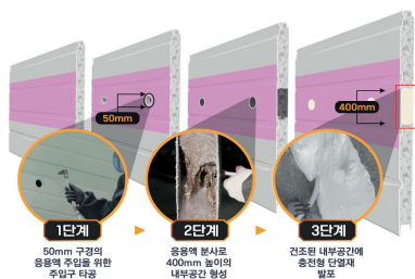
[ 기존 물류시설 마감재료 화재확산방지 공법 시공 ]
