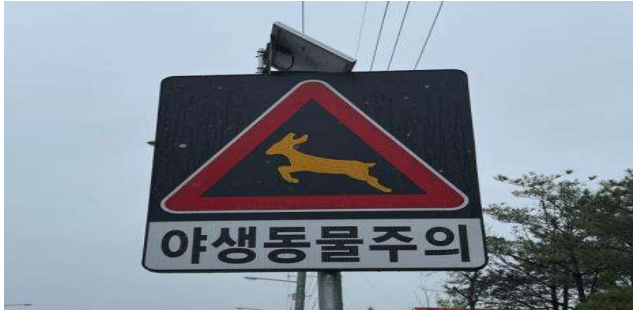
(주의표지판) 경찰청 교통안전표지 설치관리 업무편람의 야생동물보호 표지판 준용, 야간에도 잘 보이게 태양광으로 충전하는 LED 표시판
