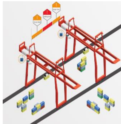
기중기, 크레인 이송 중 충돌방지
