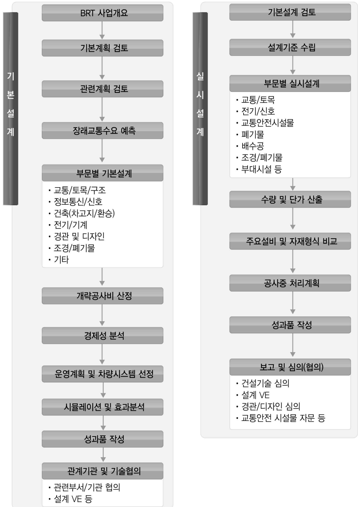
<간선급행버스(BRT) 구축 사업계획의 기본설계 및 실시설계 업무추진절차>
