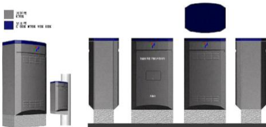
<그림 부록5-1> 모델 A 교통신호제어기 함체 외형
