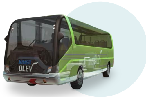
85KHz 활용 전기버스 무선충전 서비스(와이파워원)
