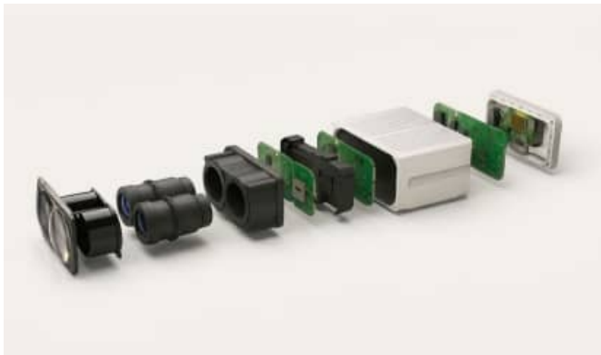
(좌)ML-X의 하드웨어 구조, (우)라이다 기반 주차 안내 시스템(LPGS SPOT®)의 3차원 공간 데이터 인지 및 주차면 감지 화면
