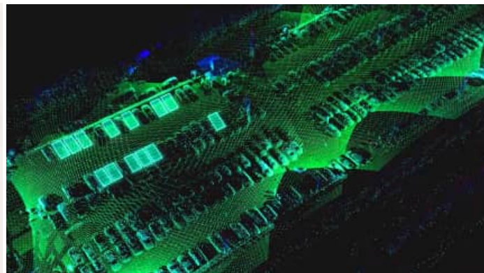
(좌)ML-X의 하드웨어 구조, (우)라이다 기반 주차 안내 시스템(LPGS SPOT®)의 3차원 공간 데이터 인지 및 주차면 감지 화면
