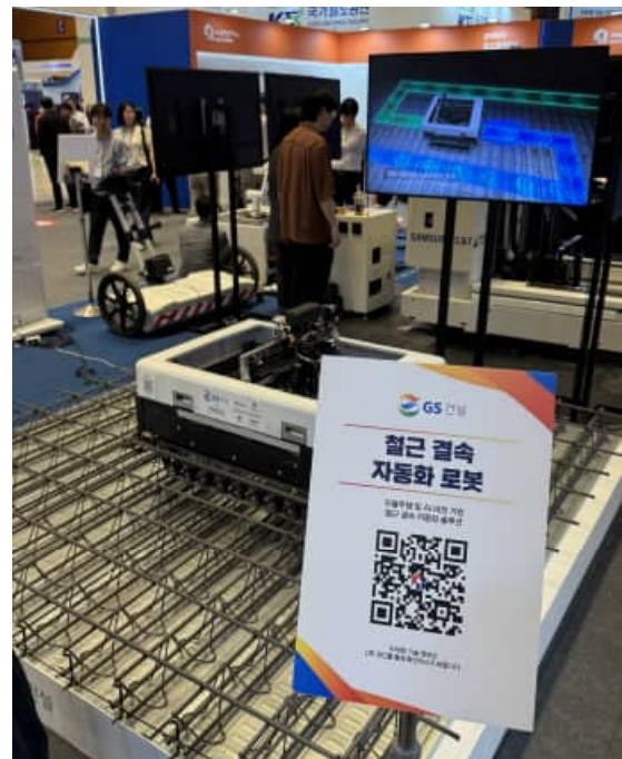
철근 결속 자동화 로봇(GS건설)
