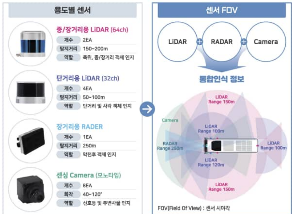
자율주행버스 탑재 센서 구성 및 통합 인식 범위(FOV) 개요
