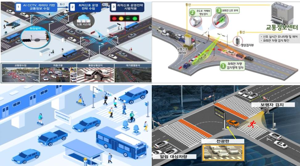
(왼쪽 위부터 시계방향) 스마트교차로, 좌회전감응신호시스템, 스마트횡단보도시스템, 우회전 보행자 안전시스템
